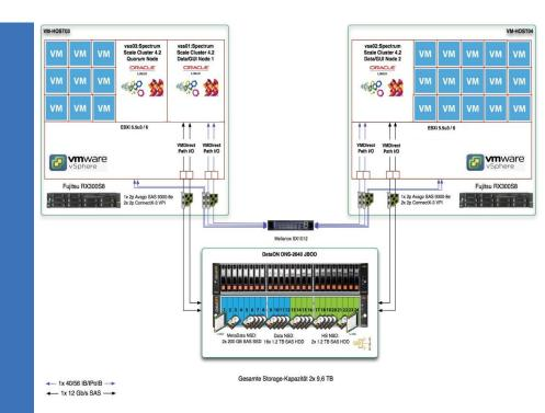
Basis: x86-Architektur (z. B. Lenovo), InfiniBand-Technologie (Mellanox)
